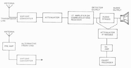
Fig. 6. Basic VHF radiometer.
